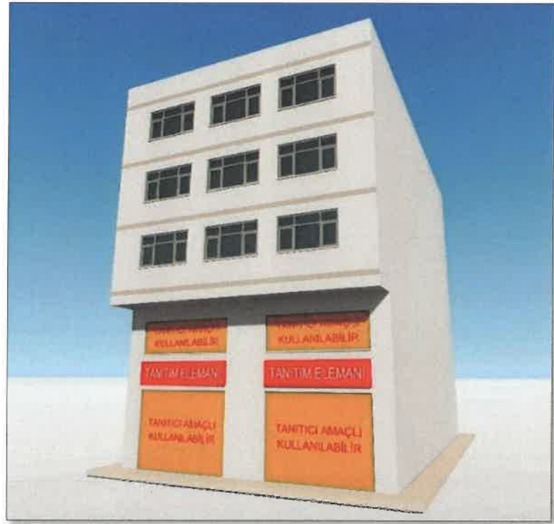
Bodrum, zemin veya asma katta faaliyet gösteren işyerlerine ait tanıtım elemanları (Şekil 5.4)
